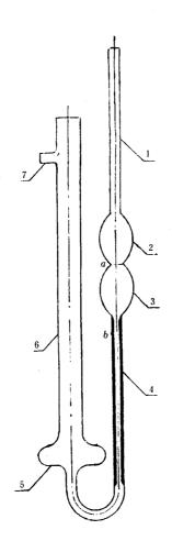
毛细管粘度计图 1,6一管身,2,3,5一扩张部分,4一毛细管,a、b—标线
