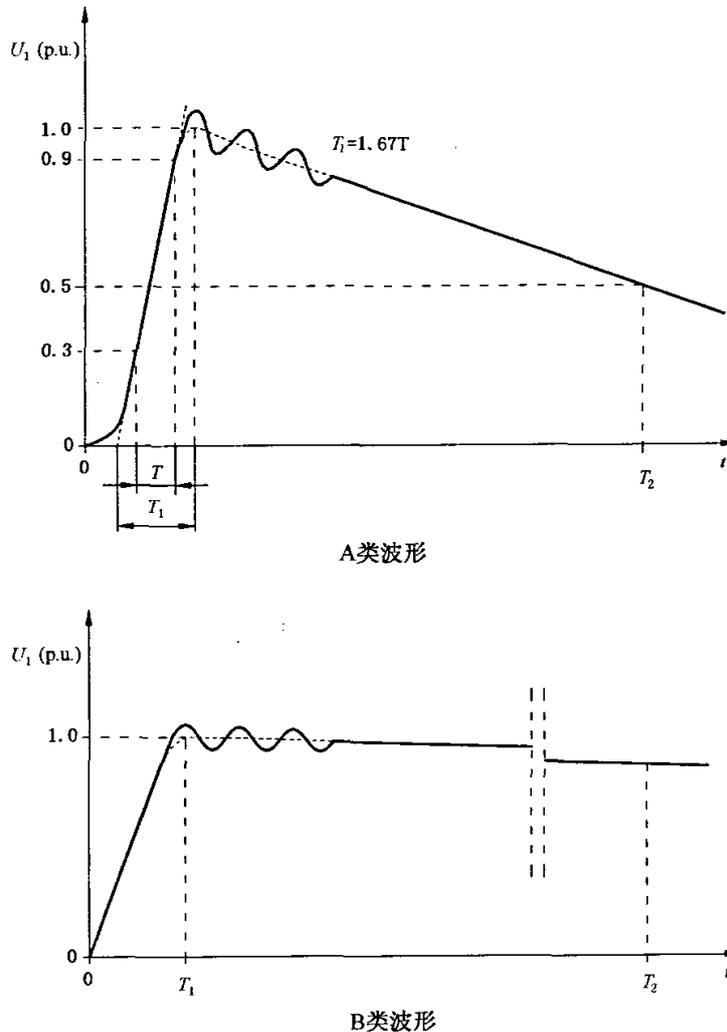
图 8 传递过电压测量:试验波形
