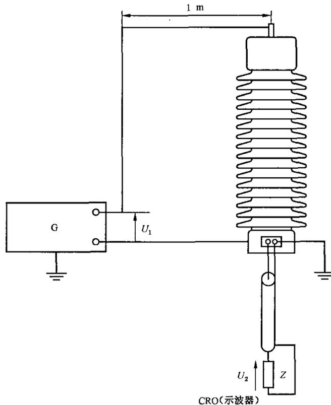
图 7 传递过电压测量:一般试验布置
