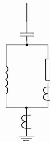
图6 阻尼滤波器支路过负荷保护示例
