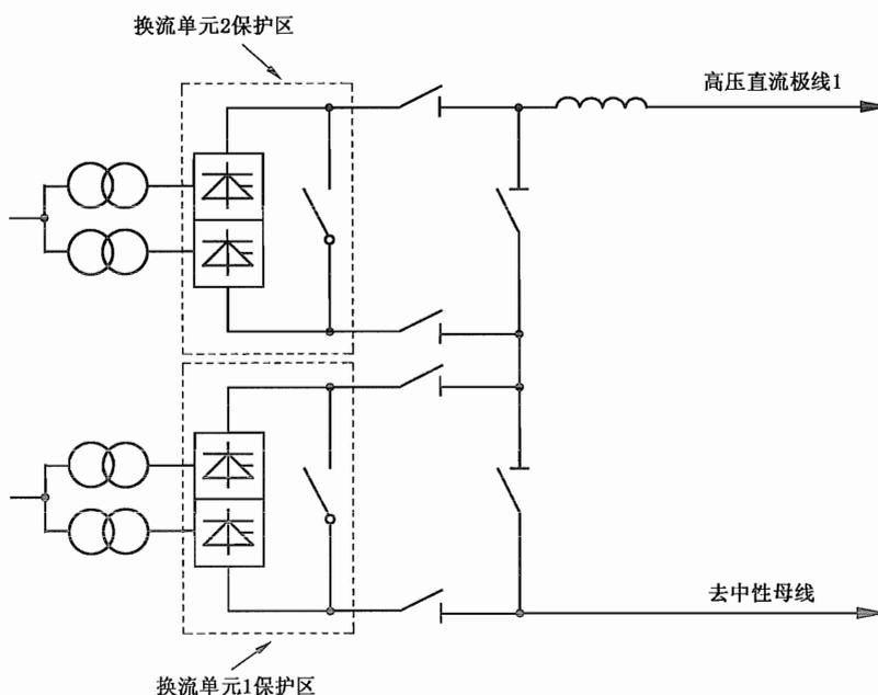
图 8 串联连接的换流器单元保护区
