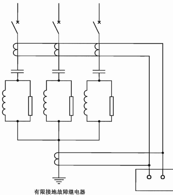
图5 滤波器有限接地故障保护示例
