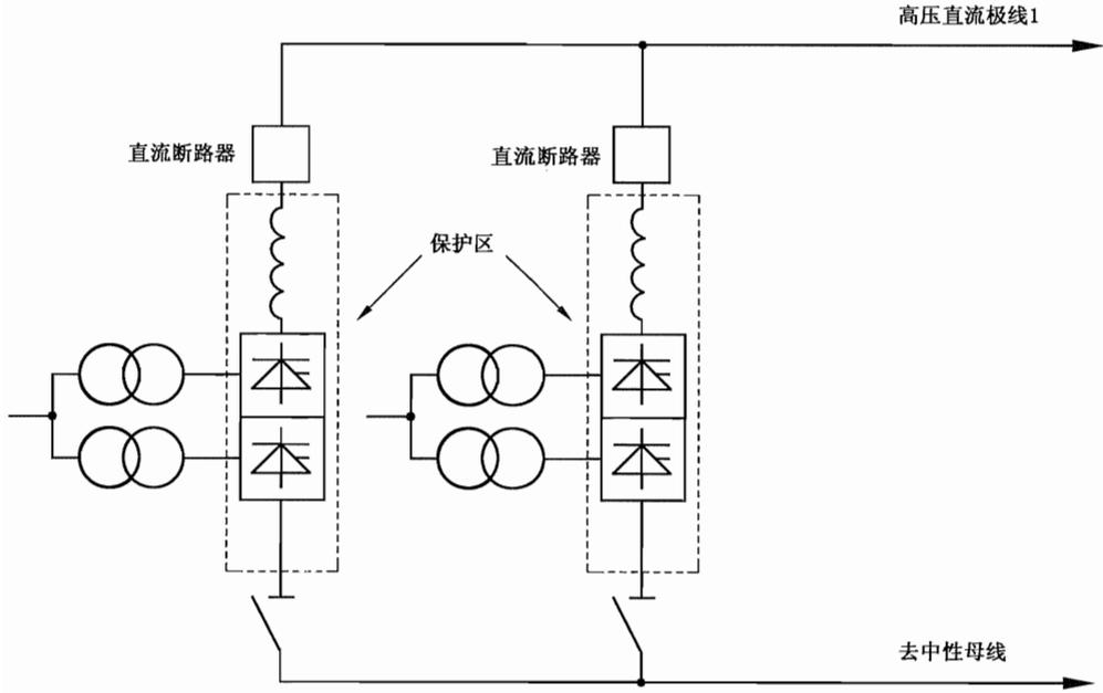
图 9 并联连接的换流器单元保护区
