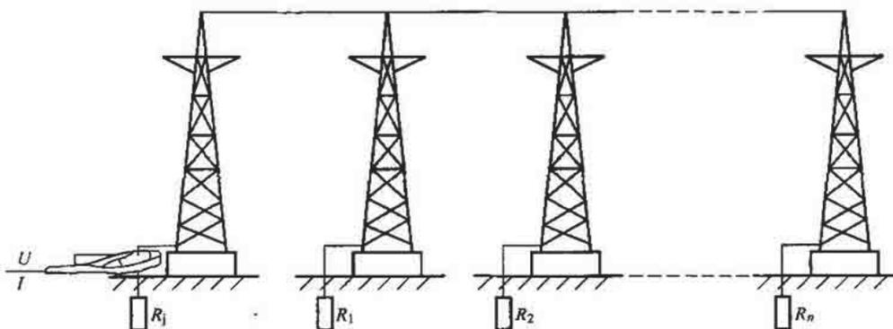
$R_j$ —被测杆塔的接地电阻； $R_1$ 、 $R_2$ 、 $\dots$ 、 $R_n$ —通过避雷线连接的各基杆塔的接地电阻；
