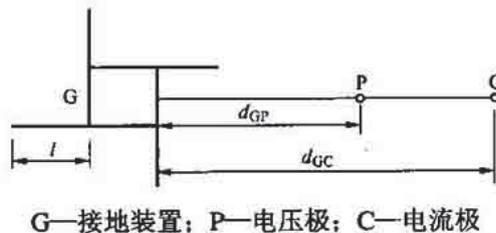
图 1 三极法测量杆塔工频接地电阻的电极布置图
