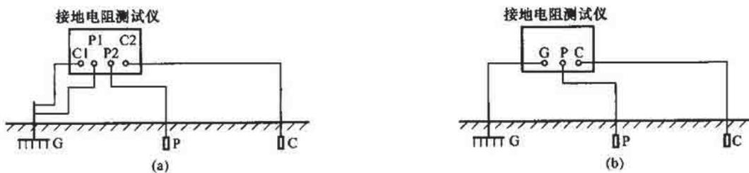
C1、C2—接地电阻测试仪的电流极接线端子；
