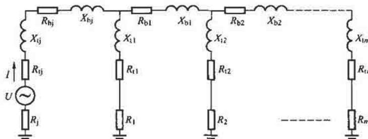
$R_{bj}$ 、 $R_{b1}$ 、 $R_{b2}$ 、 $\dots$ —各档避雷线的电阻（包括接触电阻）； $X_{bj}$ 、 $X_{b1}$ 、 $X_{b2}$ 、 $\dots$ —各档避雷线的电抗；
