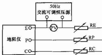
PV—1.5级低量限交流电压表；E—接地体端子；P—电压（电位）极端子；
