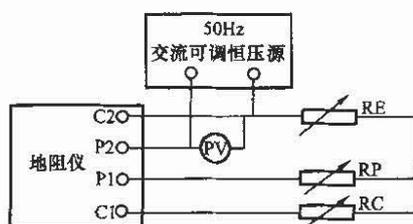
PV—1.5级低量限交流电压表；P1、P2—电压（电位）极端子；C1、C2—电流极端子；
