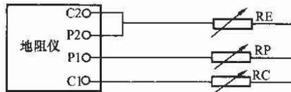
P1、P2—电压（电位）极端子；C1、C2—电流极端子；
