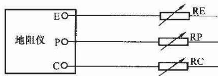
E—接地体端子；P—电压（电位）极端子；C—电流极端子；
