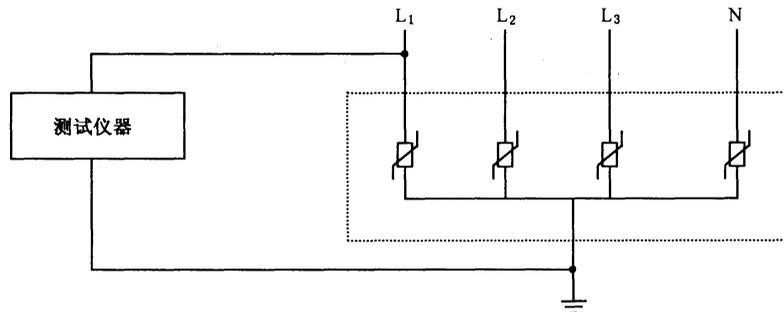
图 2 多组 SPD 逐一测试示意图
