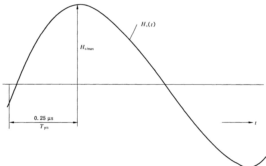
图 C.4 后续雷击磁场强度(0.25/100 μs)上升期的模拟
